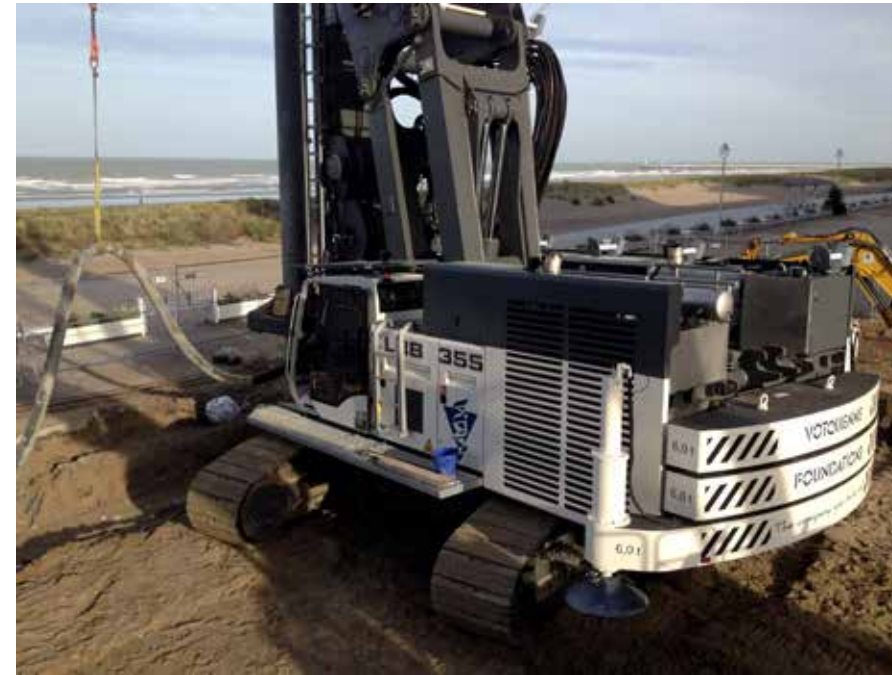
De onderwagen kan verbreed worden tot 4,7 meter en biedt zo de nodige stabiliteit.
